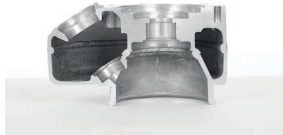
Rheocasting Luftspeicher Querschnitt mit Wandstärkensprüngen und Schweißnähten
