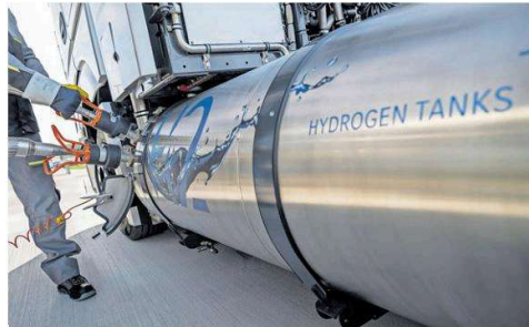
Bestankung des von SAG entwickelten LH 2 -Kryotanksystems während einer Testfahrt quer durch Deutschland
