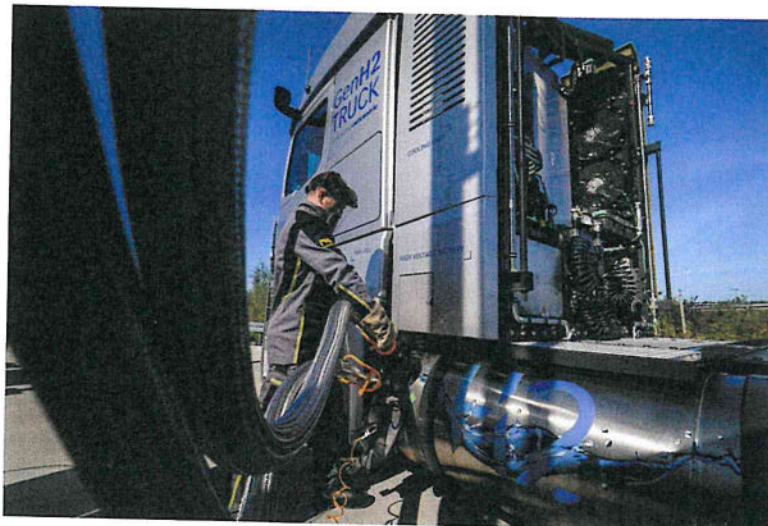
Mit einer Tankladung von 2 x 40 Kilogramm Wasserstoff und einer Nutzlast von 40 Tonnen wurde eine Strecke von mehr als 1.000 Kilometern bewältigt
