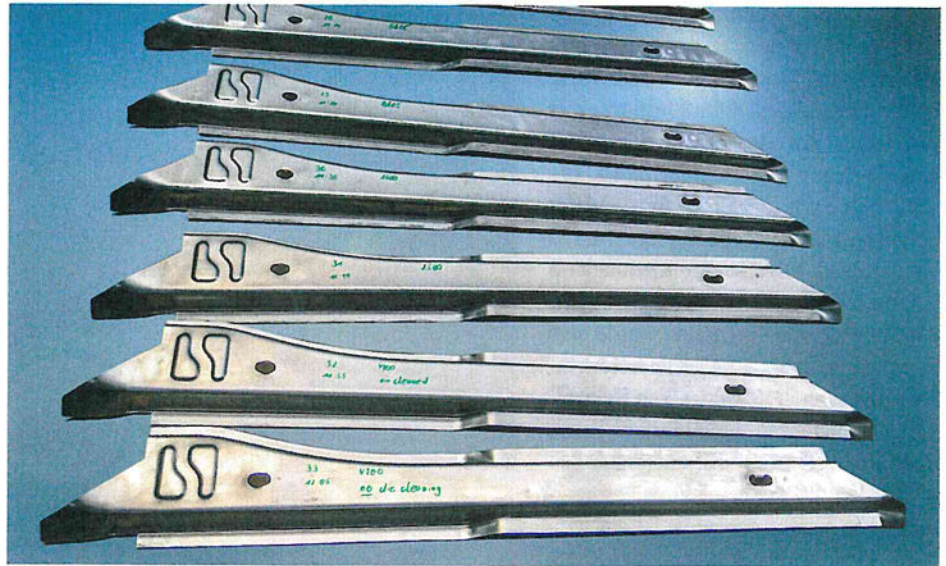
Bauteile aus hochfestem Aluminium kommen in Fahrzeugen immer häufiger zum Einsatz, um Gewicht zu sparen / Parts made from high-strength aluminum sheets are increasingly being used in vehicles to save weight
