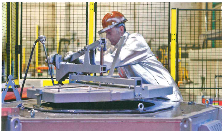
Rheocasting-Mitarbeiter beim Nachfüllen von Rohmaterial
